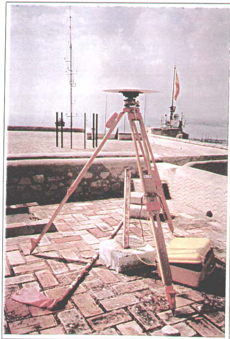
Foto 10 y 11.- Receptor en vértice geodésico Castillo Santa Barbara
