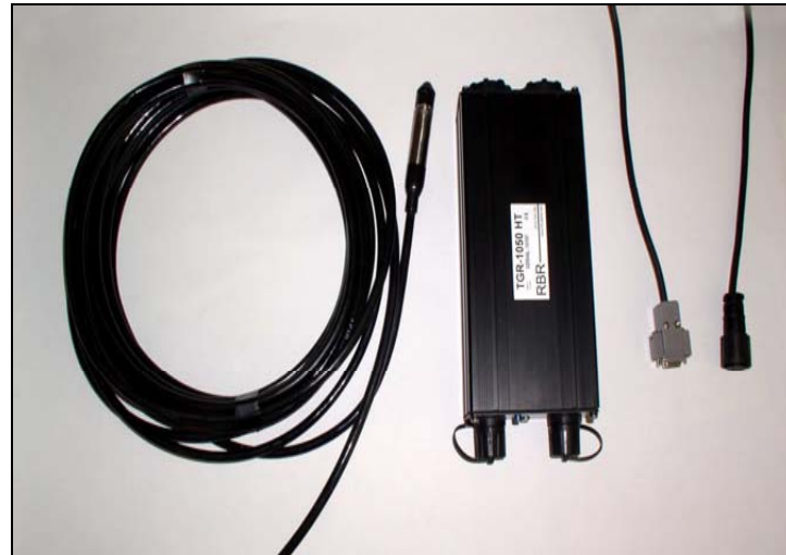
Imagen 2.3.1. Mareógrafo propio modelo TGR-1050 HT.
