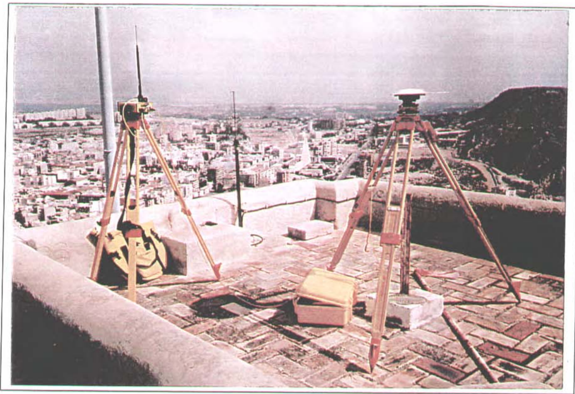
Foto 10 y 11.- Receptor en vértice geodésico Castillo Santa Barbara
