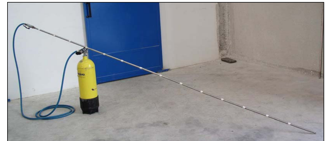
Imagen 2.4.1. Lanza de aire utilizada (3 metros de longitud).
