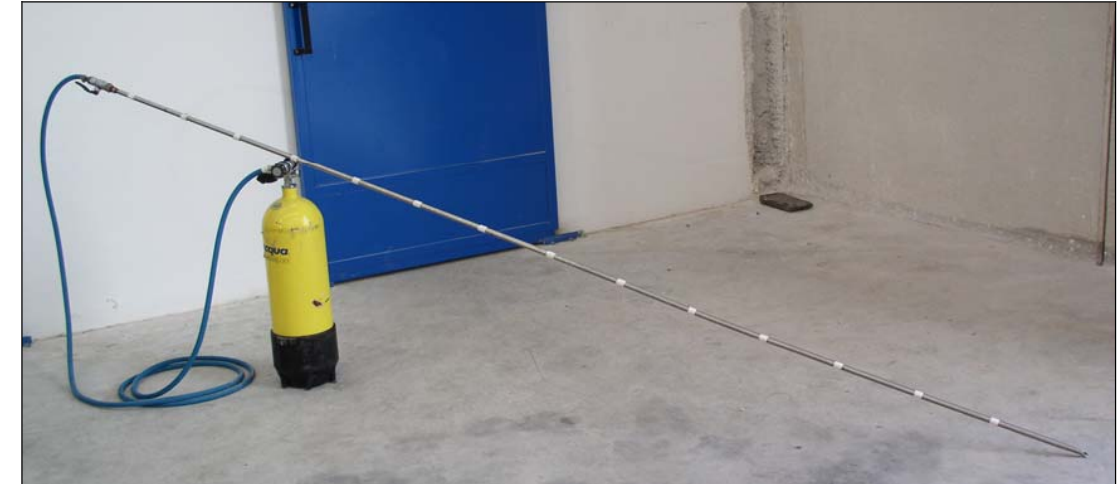
Imagen 2.4.1. Lanza de aire utilizada (3 metros de longitud).
