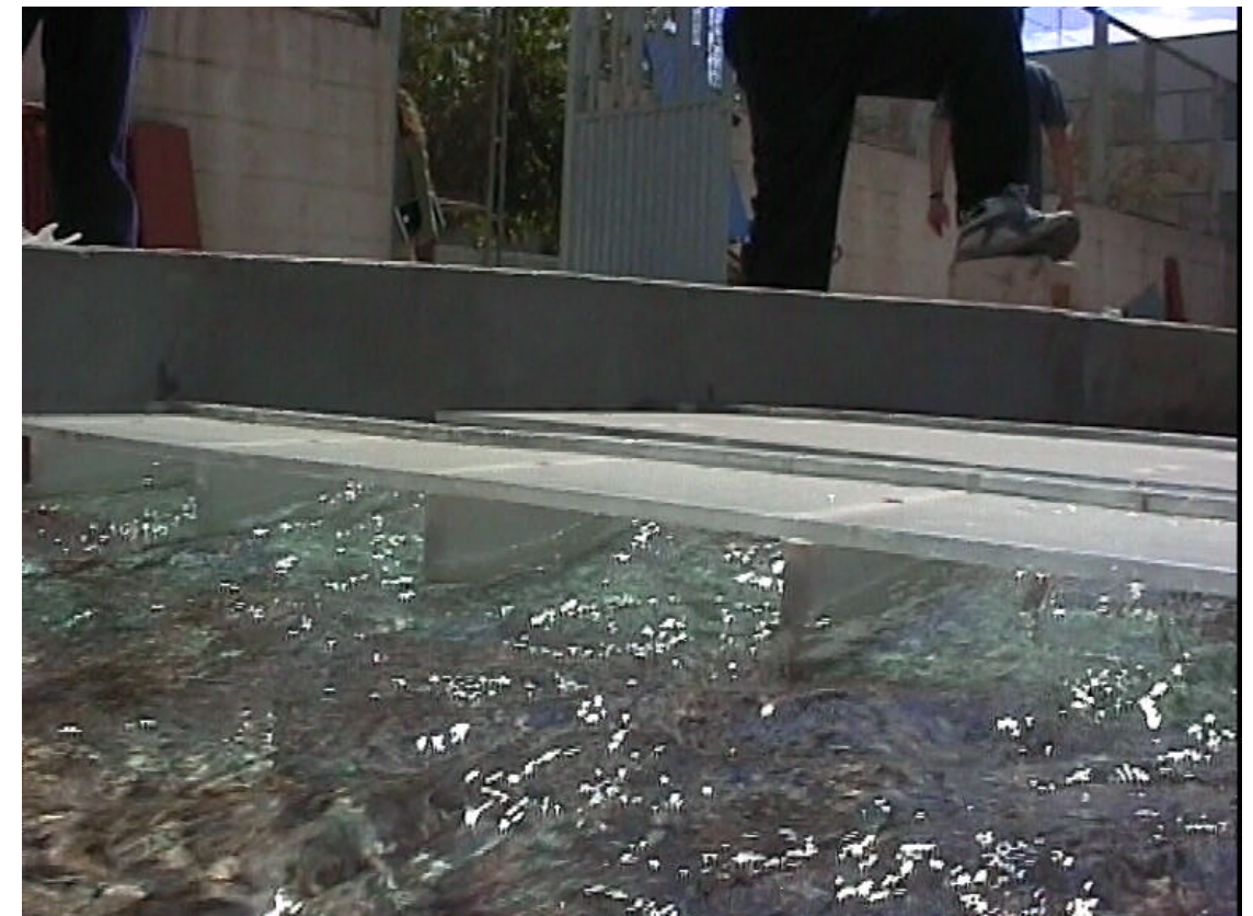
FOTO 55.- Peralte transversal del flujo a través de los vanos del puente del ferrocarril. Al fondo la margen derecha del cauce.
