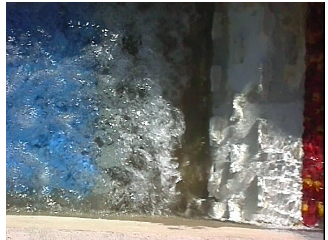
FOTO 47. - Fijación del resalto hidráulico por la estructura de disipación. Vista cenital.
