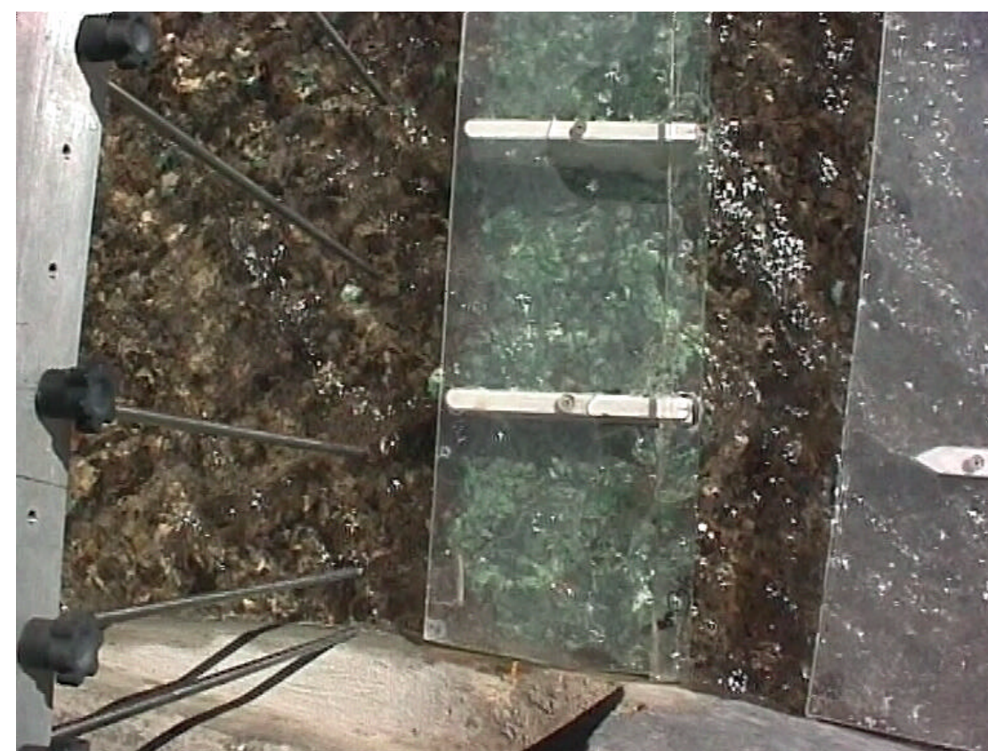
FOTO 90.- Vista cenital del funcionamiento hidráulico bajo los puentes en la zona anteriormente conflictiva. Aunque el flujo mejora, el efecto desfavorable de las pilas respecto del flujo no se puede evitar y se aprecia una componente transversal del mismo hacia el centro del cauce, pero sin provocar erosiones localizadas.
