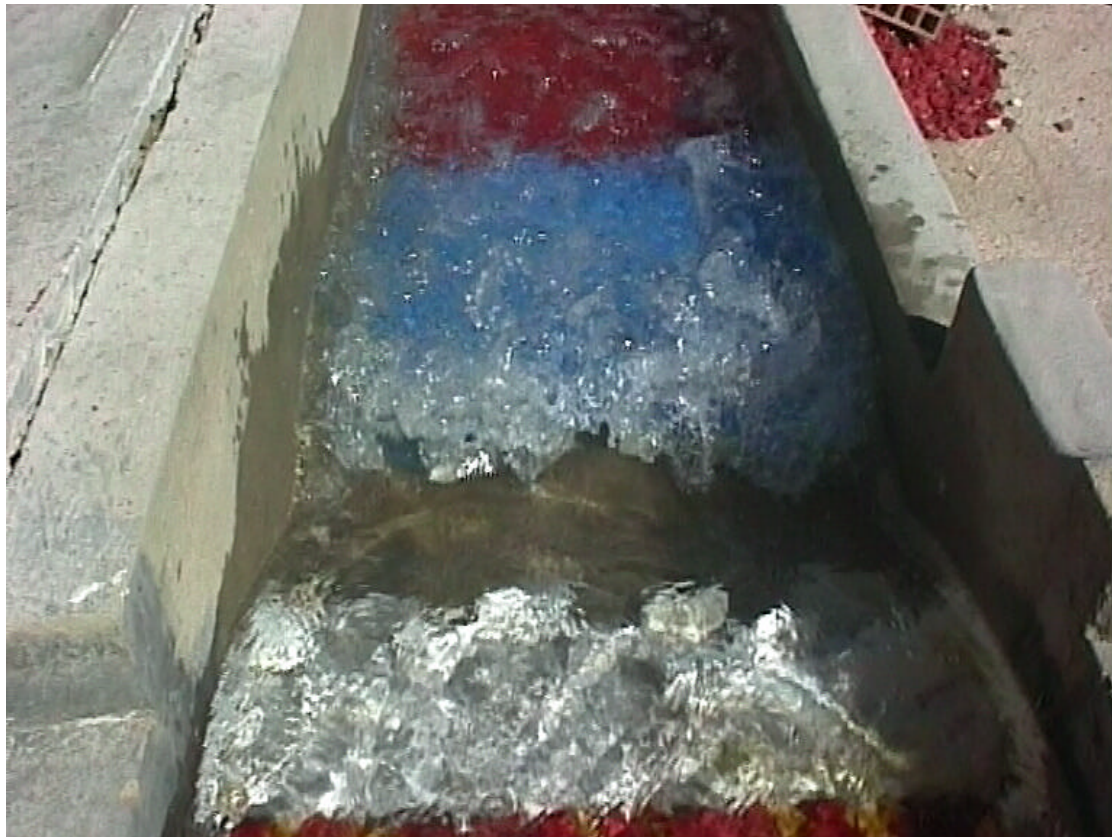
FOTO 58.- Vista hacia aguas abajo del funcionamiento hidráulico de la estructura de disipación. El amortiguamiento del oleaje generado se amortigua en la longitud de cauce esperada (zona de escollera en azul).
