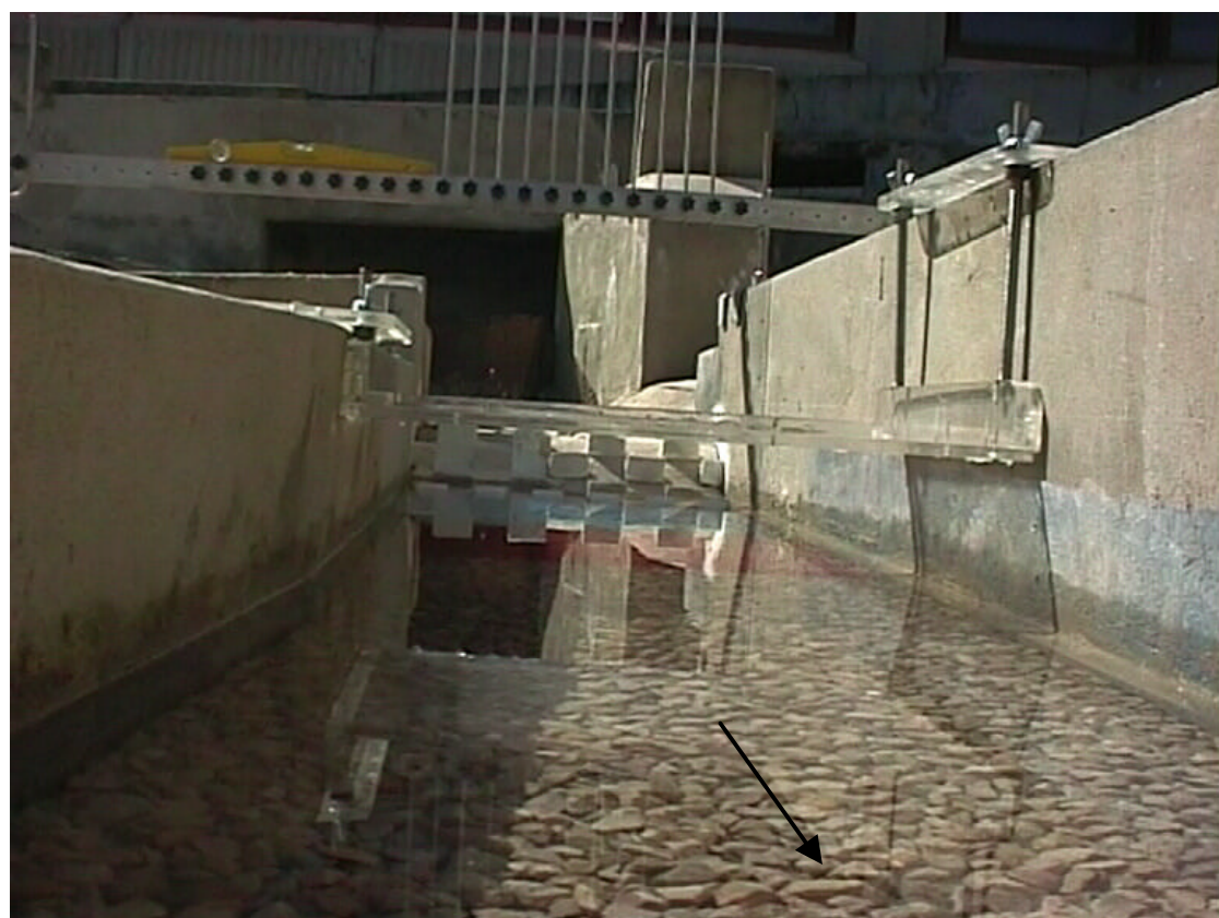
FOTO 12.- Vista hacia aguas arriba del azud de San Gabriel y Puente de C/Paraguay. Lámina de agua en situación Q.
