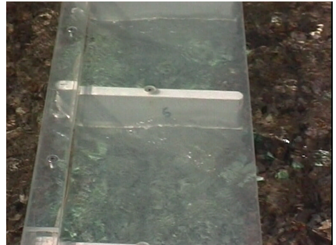
FOTO 38.- detalle del flujo alrededor de una de las pilas del puente de ferrocarril.
