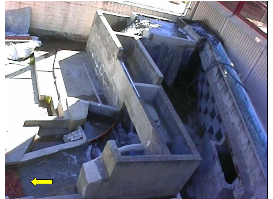
FOTO 1.- Arquetas de recepción, tranquilización y medición de caudales, en cabecera del modelo físico.
