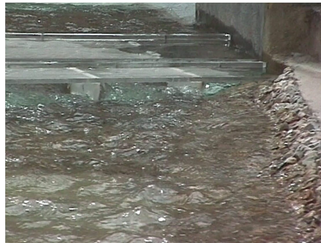
FOTOS 71 y 72.- Vistas del peralte trasnversal de la superficie libre a la salida del puente del ferrocarril.
