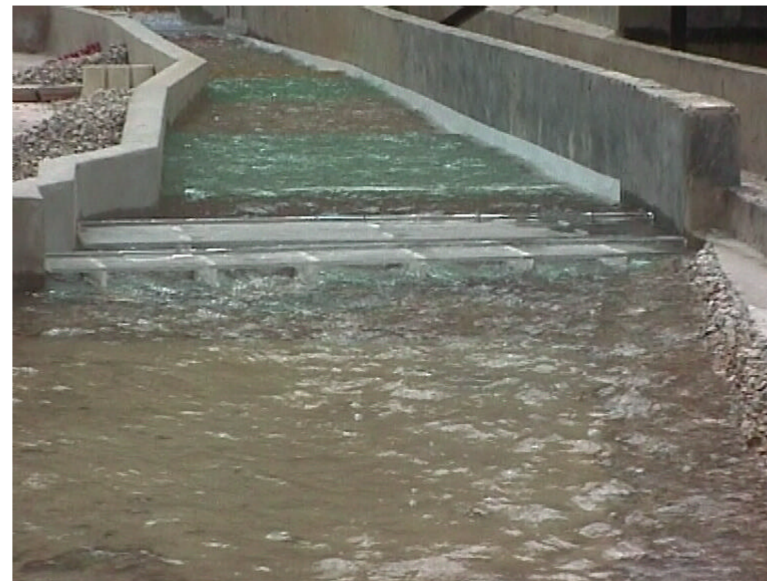
FOTOS 71 y 72.- Vistas del peralte trasnversal de la superficie libre a la salida del puente del ferrocarril.
