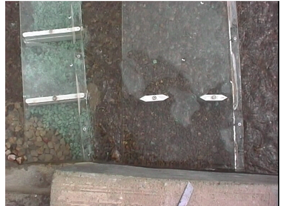
FOTOS 67 y 68.- Distintas vistas del malfuncionamiento de los vanos de ambos puentes por efecto del cierre del dique-espigón. La diferencia en color indica la zona que funciona en carga.
