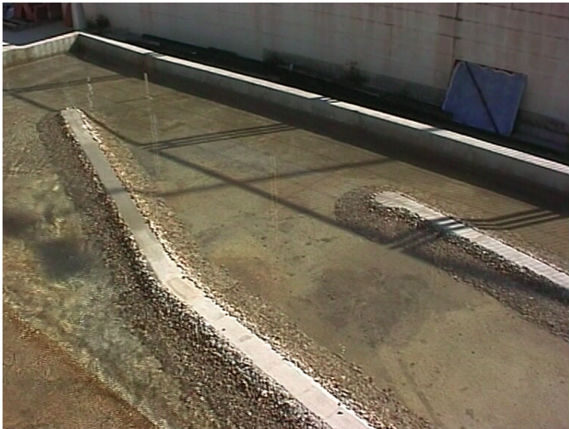
FOTOS 27 y 28.- Zona de desembocadura del barranco de Las Ovejas. Vista de los diques-espigones y balsa de control de niveles del mar.
