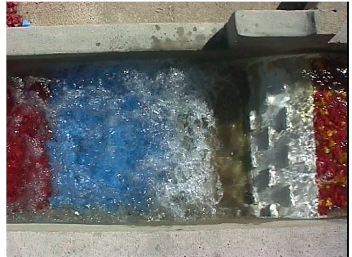
FOTO 57. - Fijación del resalto hidráulico por la estructura de disipación. Vista cenital.
