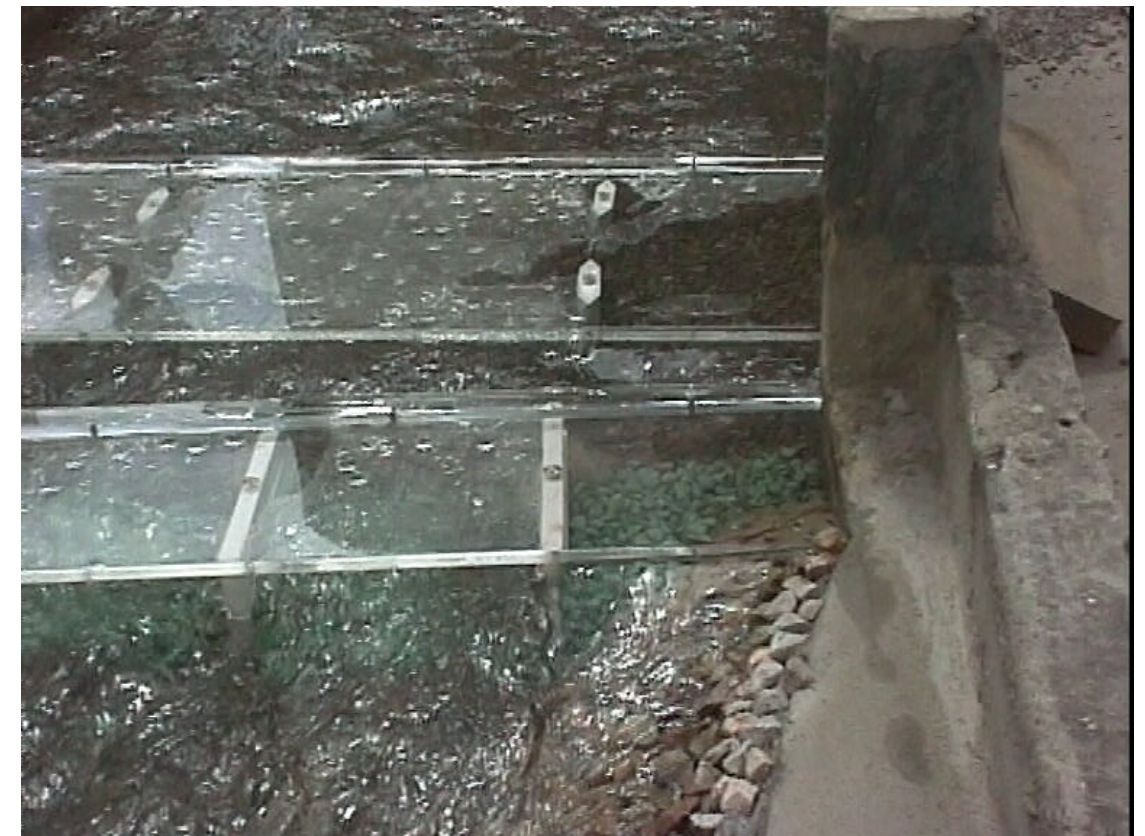
FOTOS 67 y 68.- Distintas vistas del malfuncionamiento de los vanos de ambos puentes por efecto del cierre del dique-espigón. La diferencia en color indica la zona que funciona en carga.
