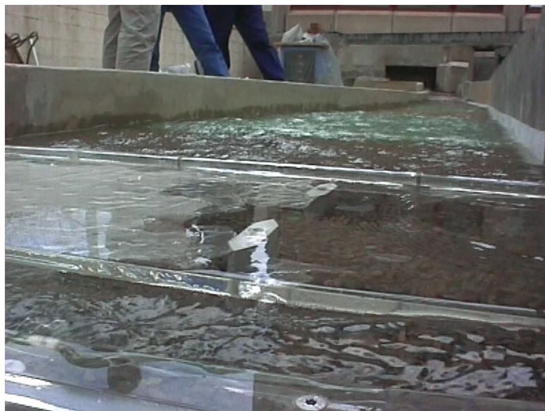
FOTOS 69 y 70.- Vistas desde aguas abajo, del malfuncionamiento de los vanos de ambos puentes por efecto del cierre del dique-espigón. La diferencia en color indica la zona que funciona en carga.
