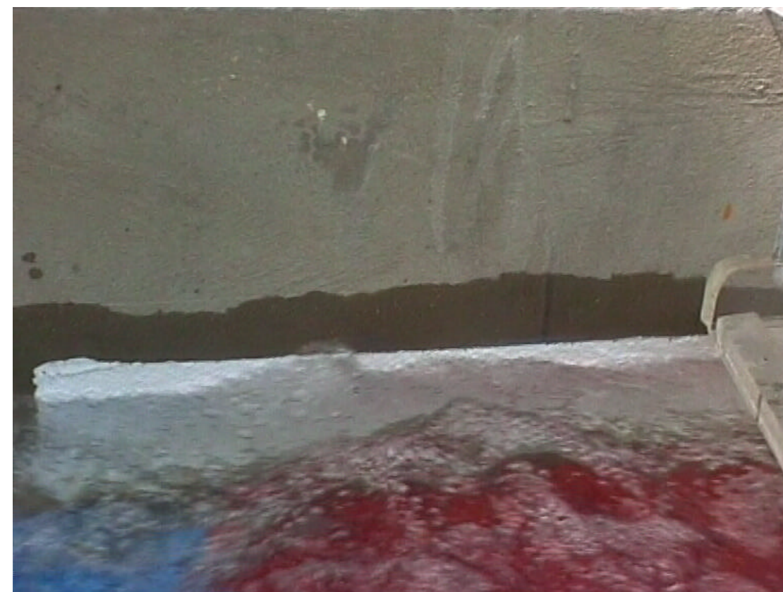
FOTOS 94 a 99.- Visualización de los Resguardos a lo largo del cajero actual, al paso del caudal de diseño. En esta foto, resguardos a la salida del Salto de San Gabriel, hasta la entrada al puente d C/ Paraguay.
