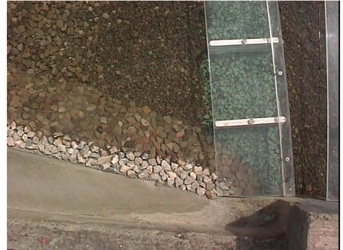
FOTO 25.- Vista cenital de la contracción generada por el dique-espigón.
