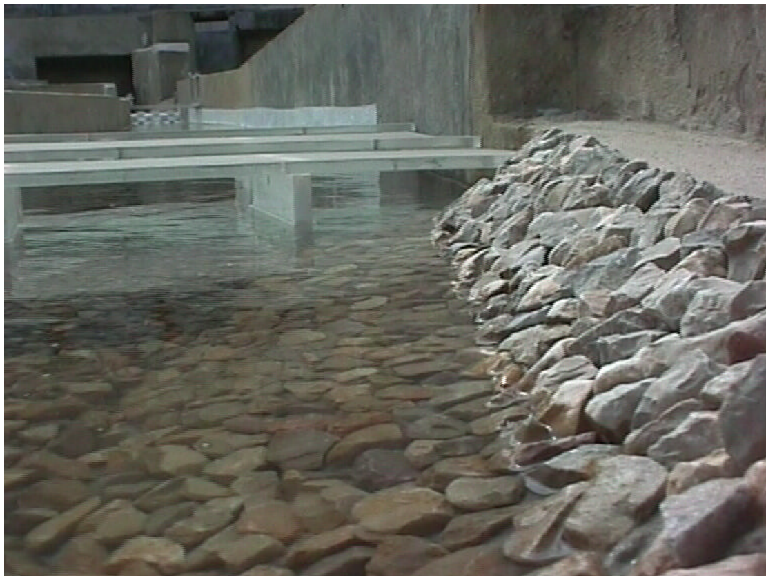
FOTO 24.- Vista desde aguas abajo, del efecto de contracción del flujo que genera el dique-espigón.
