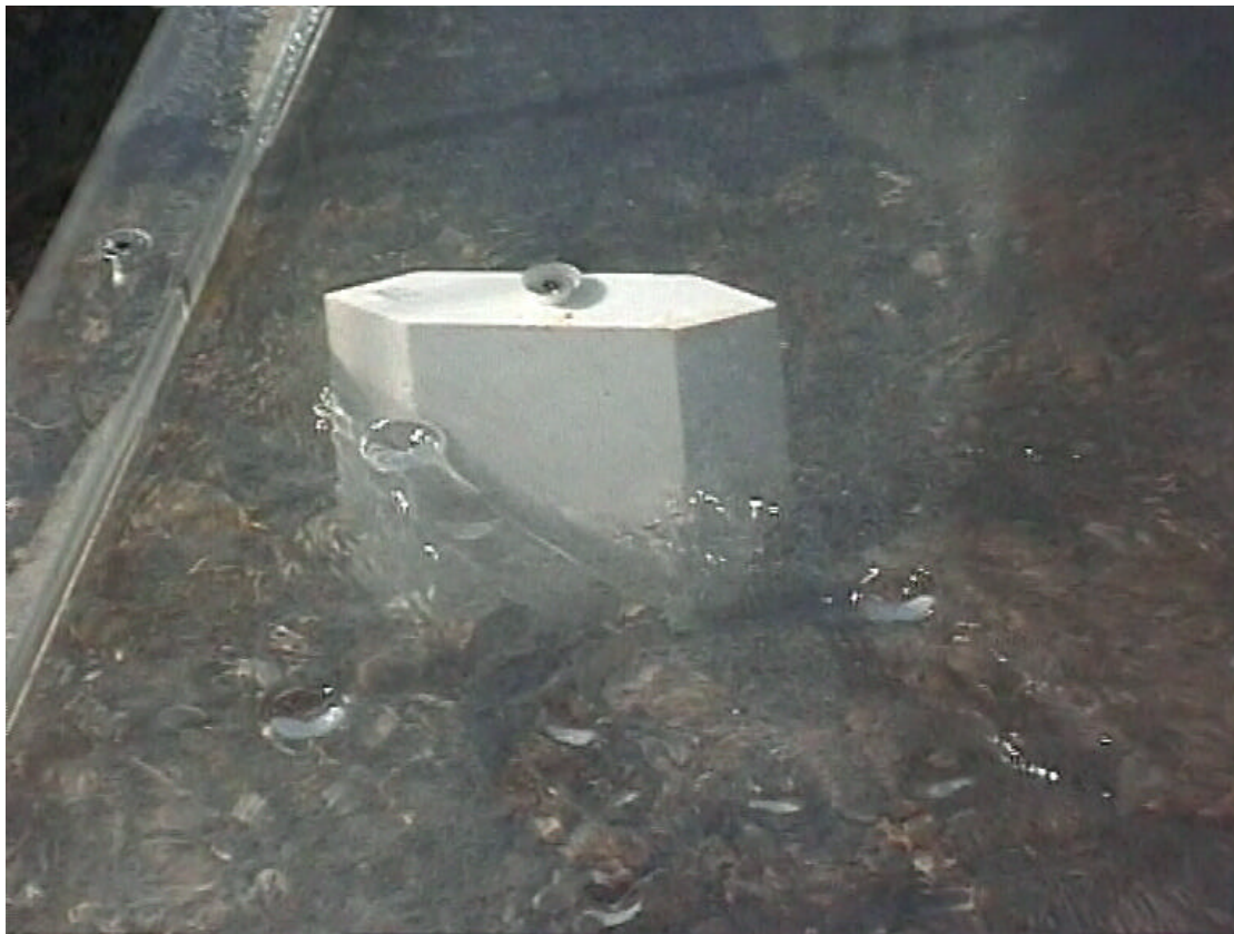
FOTO 36.- Detalle del flujo alrededor de una de las pilas del puente de la N-332.
