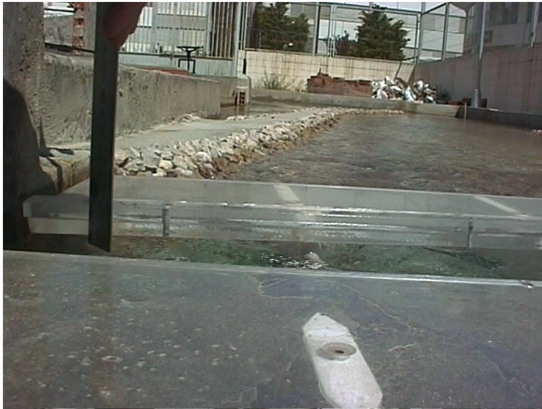
FOTO 43.-Flujo bajo los puentes. Zona de la margen izquierda. El resguardo medido bajo el puente del ferrocarril es estricto (0.50 m.)
