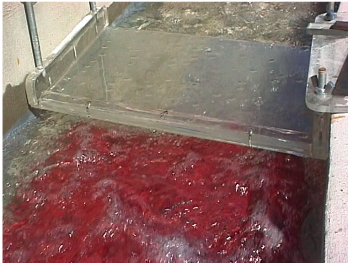
FOTOS 61 y 62.-El resguardo bajo el puente de C/Paraguay es adecuado al paso del caudal de diseño.
