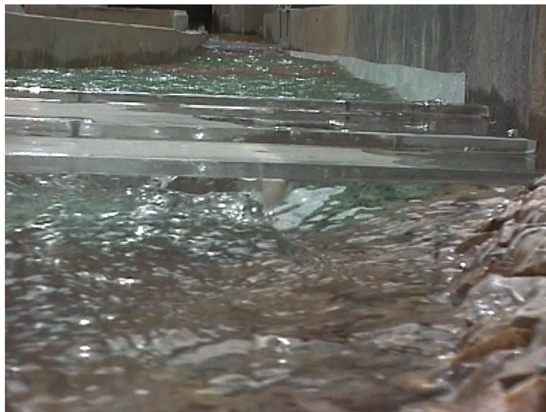
FOTOS 69 y 70.- Vistas desde aguas abajo, del malfuncionamiento de los vanos de ambos puentes por efecto del cierre del dique-espigón. La diferencia en color indica la zona que funciona en carga.
