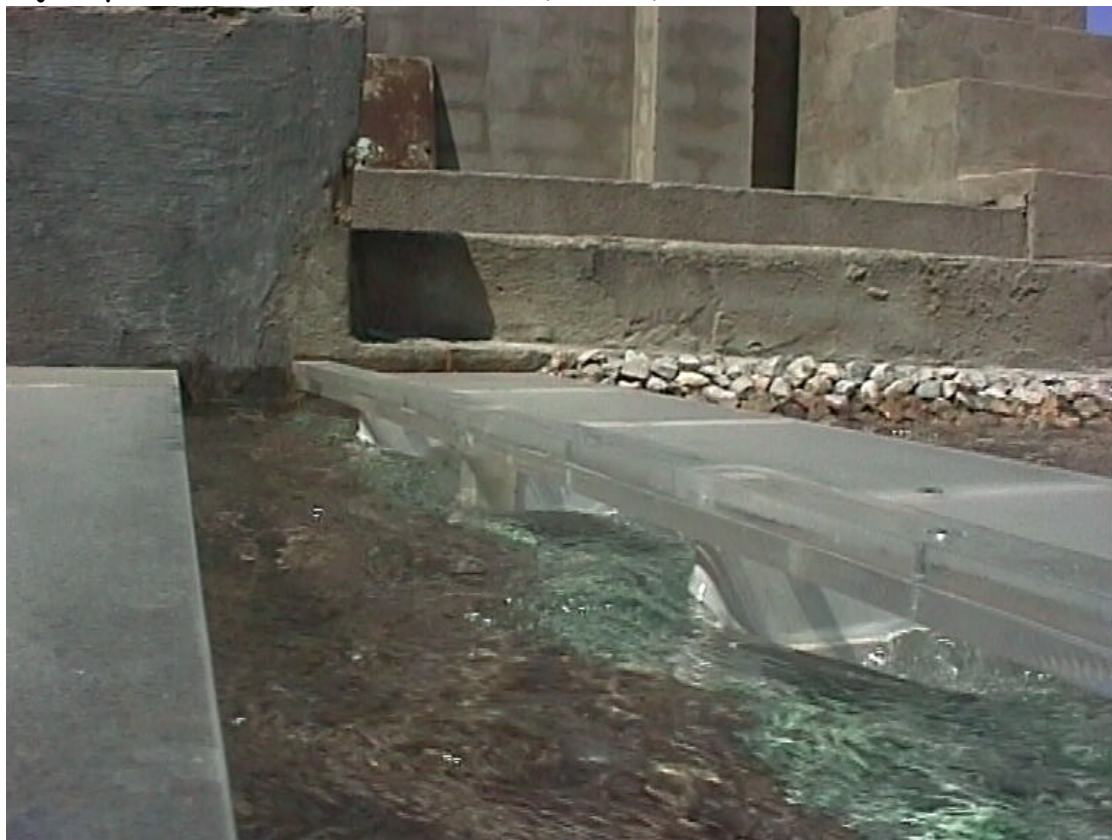
FOTO 44.- Peralte transversal de la superficie libre generado por: a) Obstrucción del vano izquierdo, b) ensanchamiento asimétrico del cauce y c) esviaje del eje de las pilas respecto de la dirección del desagüe.
