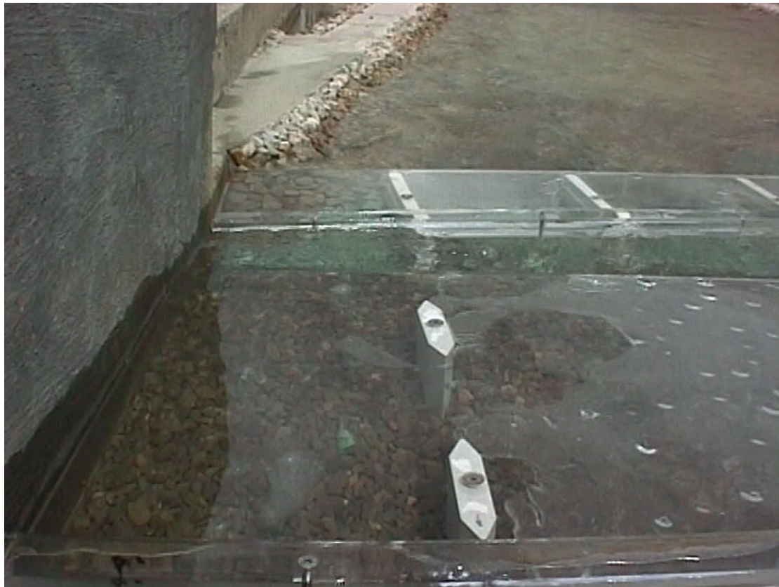
FOTOS 65 y 66.- Los vanos de la margen izquierda de los puentes de la N-332 y del ferrocarril funcionan en carga y el efecto de remanso provoca el vertido sobre los tableros.
