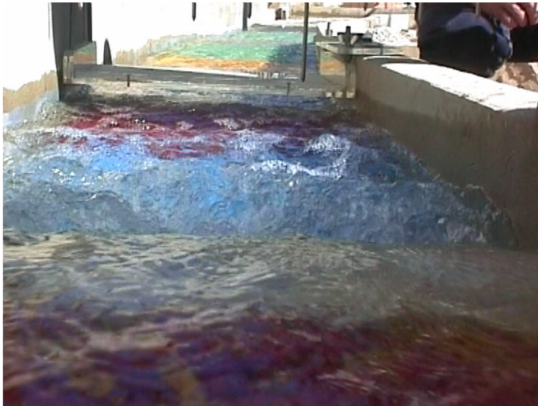
FOTO 48.- Vista del flujo vertiente sobre el azud de San Gabriel. Se aprecia la turbulencia generada por el resalto hidráulico, que se amortigua rápidamente antes de pasar bajo el puente de C/Paraguay.
