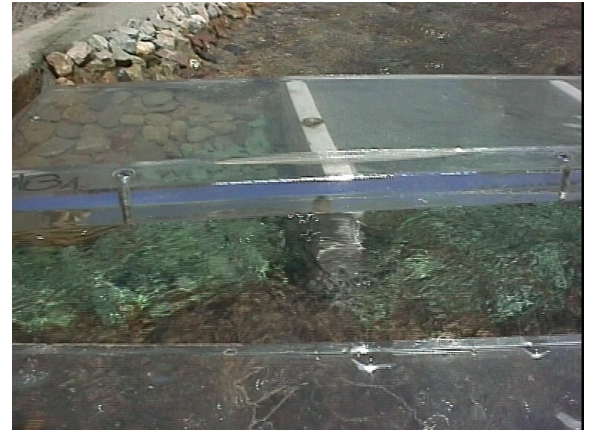
FOTO 51.- Flujo bajo el vano extremo del puente del ferrocarril. Se aprecia que ha entrado en carga (diferente transparencia en la foto).
