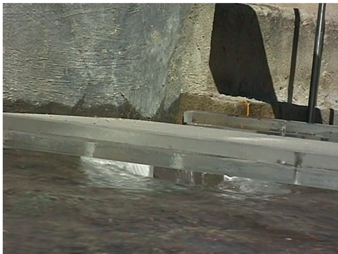
FOTOS 87 y 88.- El vano de la margen izquierda deja de funcionar en presión para el caudal de proyecto. En la imagen, el espesor de cada placa de metacrilato es de 1 cm.( 0.50 m. en el prototipo).
