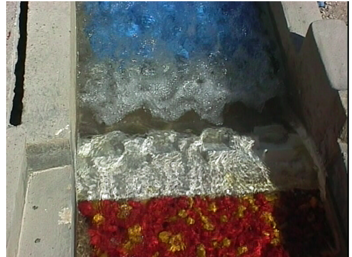
FOTO 29.- Salto de San Gabriel. Localización del resalto hidráulico en el cuenco.
