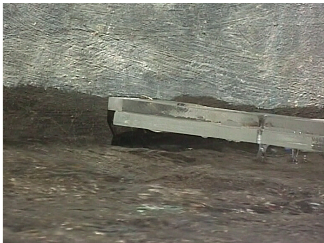
FOTOS 87 y 88.- El vano de la margen izquierda deja de funcionar en presión para el caudal de proyecto. En la imagen, el espesor de cada placa de metacrilato es de 1 cm.( 0.50 m. en el prototipo).
