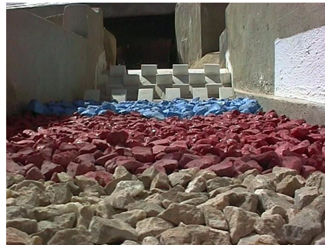
FOTO 10.- Vista a pie de escollera y hacia aguas arriba, del salto de San Gabriel.
