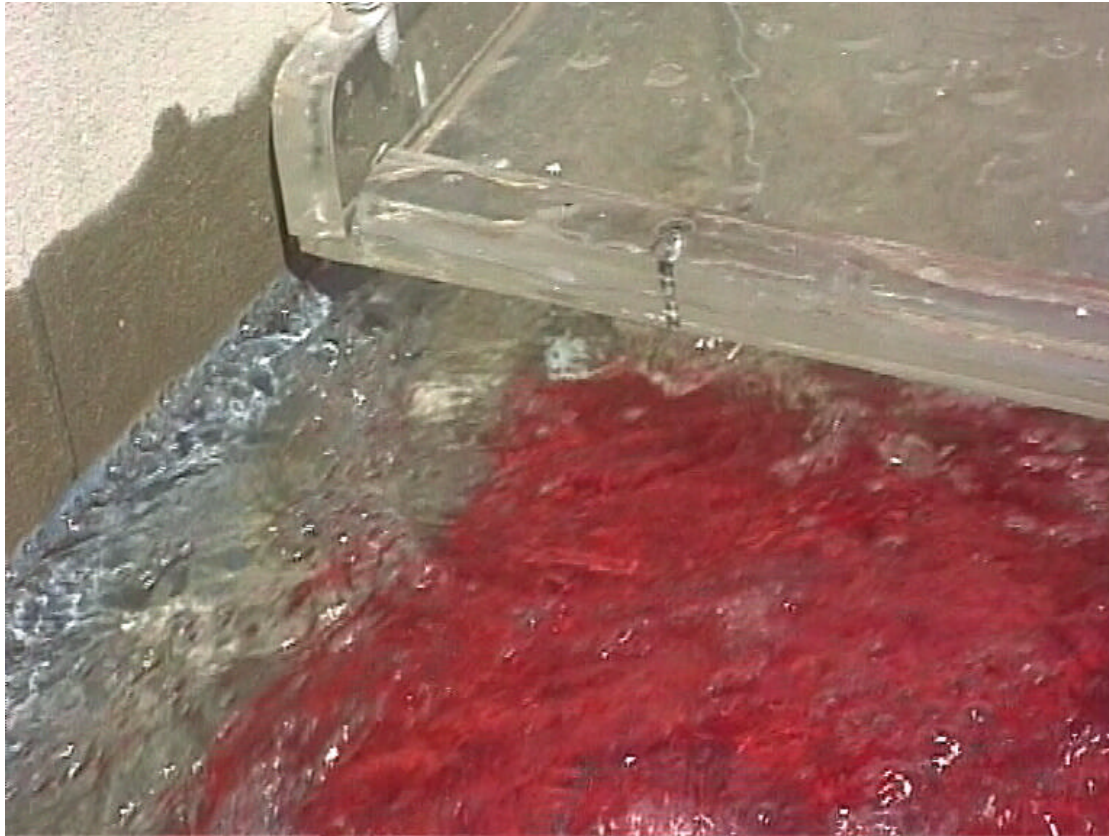
FOTOS 61 y 62.-El resguardo bajo el puente de C/Paraguay es adecuado al paso del caudal de diseño.
